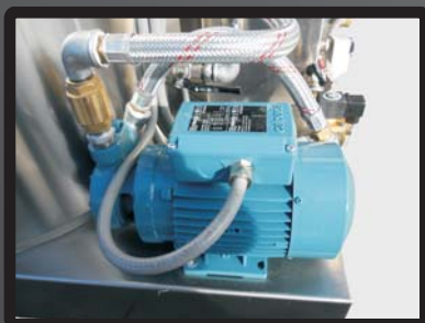
Pompa di alimentazione
